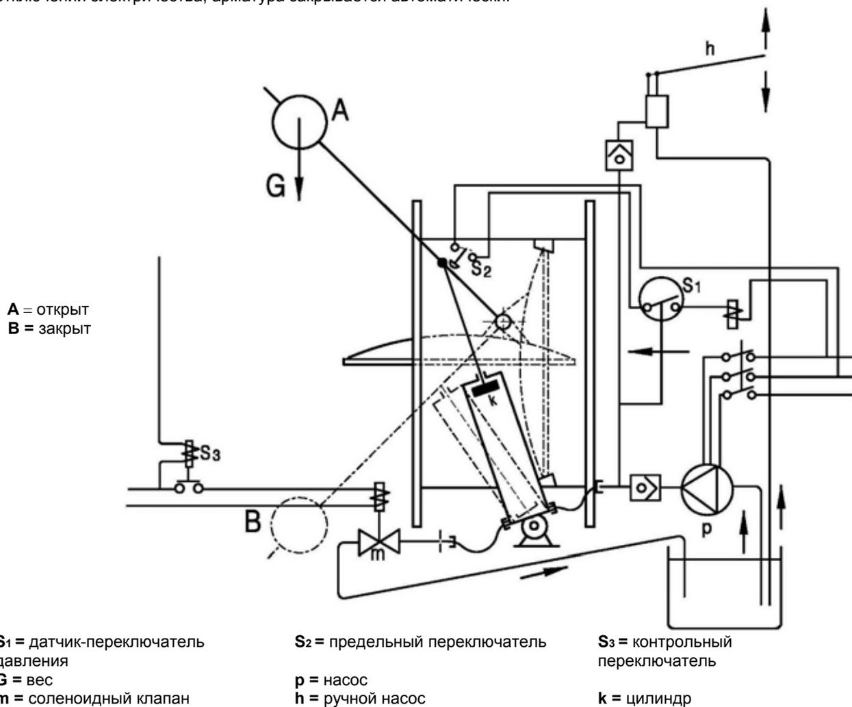
В дополнение к возможности регулировки режима закрывания, поворотный дисковый затвор с гидравлической системой открытия позволяет осуществлять открытие клапана гидравлическим цилиндром, который при закрывании служит как амортизатор. После завершения открывания, заслонка фиксируется в полностью открытом положении. Благодаря этому сопротивление потоку очень мало, и клапан особенно подходит для условий низких скоростей потока, при которых клапан полностью не откроется.
