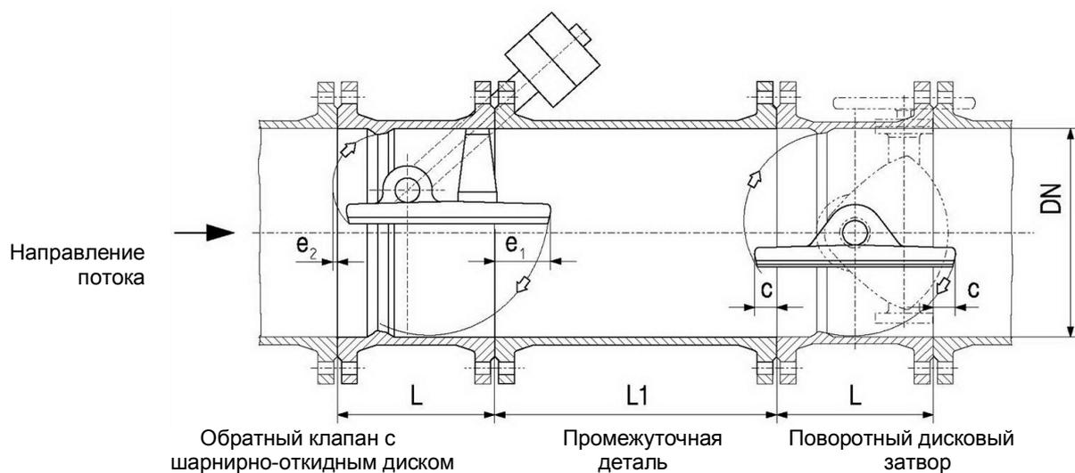
Установка должна быть осуществлена таким образом, чтобы рычаг с грузом обратного клапана с откидным диском был слева по направлению потока, а редуктор поворотного дискового затвора справа по направлению потока, чтобы рычаг и редуктор не препятствовали друг другу.
