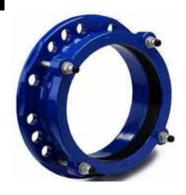
Рабочее давление до 16 бар. Угловое отклонение 6° для муфт. Фланец адаптера одновременно соответствует ГОСТ 12820-80, DIN, BS и ANSI.
