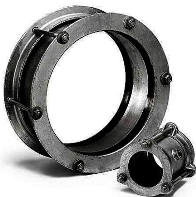
Фланцевые адаптеры и понижающие переходные муфты ROMACON, точно соответствующие наружному размеру труб, служат для соединения большинства типов гладких концов жестких труб или для присоединения гладкого конца трубы к фланцевой фасонной части, трубе или запорной арматуре. Рабочее давление может варьироваться от 10 до 40 бар, в зависимости от назначения.
