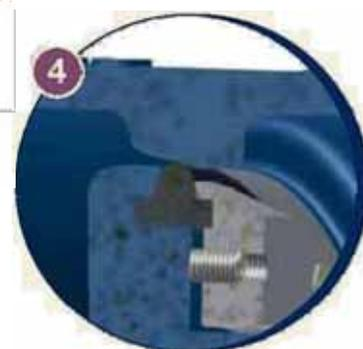
Уплотнения крепятся на диске с помощью цельного стопорного кольца и крепежных болтов, гарантируя герметичность при эксплуатации.
