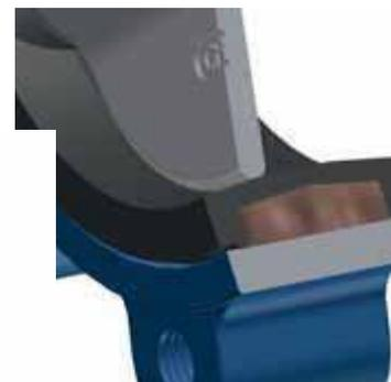
Заменяемая самоуплотняющаяся манжета из EPDM или NBR, вулканизированная на фенольную (DN 40 – DN 300) или алюминиевую (DN 350 – DN 1200) кольцевую подкладку
